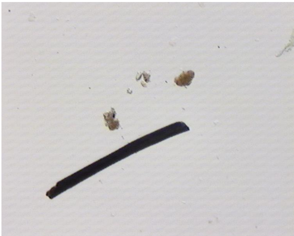
Fot. 91. Obraz mikroskopowy fragmentu włosa wybarwionego na kolor czarny odczynnikiem cystynowym (50x).
