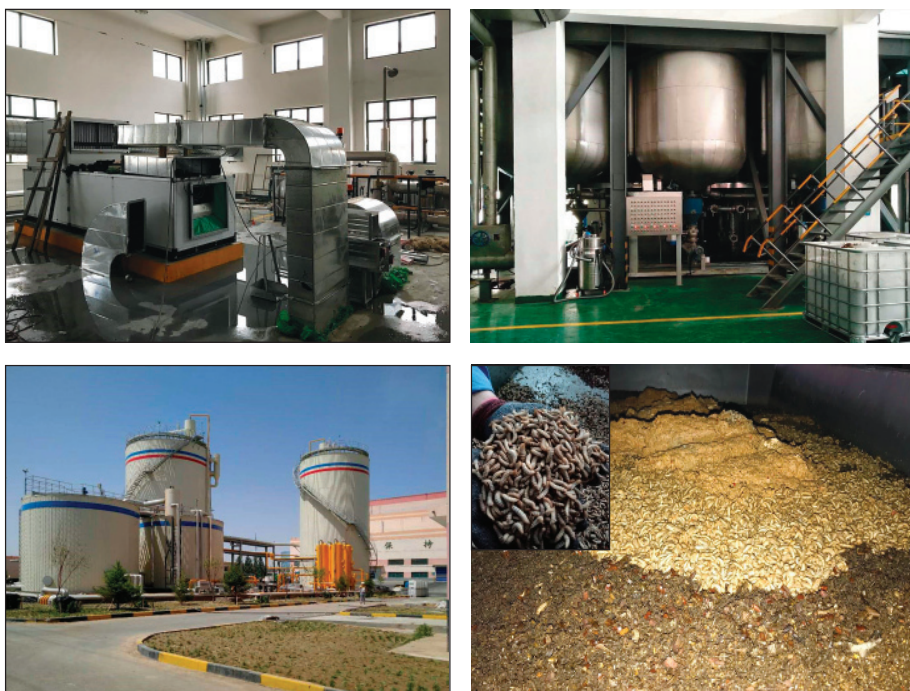
Ryc. 15. Zautomatyzowany zakład przetwarzania odpadów z łańcucha rolno -spożywczego na bazie hodowli Hermetia illucens (mucha czarna) w prefekturze Baotou (Chiny), gdzie jest utylizowane ponad 100 ton odpadów organicznych dziennie, wykorzystywanych do produkcji biogazu oraz białka owadów o masie około 1,3 tony dziennie (źródło: EVO Conversion Systems, LLC).
